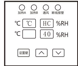
2.7 485通讯地址：仪器在工作状态下按设置键六次，进入485通讯地址设置界面后，仪器显示如右图。Add：为设定序号，1为485的通讯地址值，修改完毕后，按设置键自动保存定值，且仪器自动转入测量状态，此时所有值设置完成。
