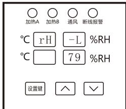
2.3、湿度上限值设定：仪器在工作状态下按设置键三次，进入湿度上限值设置界面如右图。rH-H：表示湿度上限，85：为设置湿度上限值。按上或下键修改。修改完毕后，再按一次设置键，进入温度下限设置界面。
