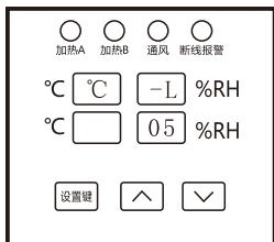
2.5、温度上限值设定：主界面下按设置键五次，进入温度上限值界面如右图。°C-H：表示摄氏温度上限，15：为温度上限值，按上下键修改湿度下限值，修改完毕后，再按一次设置键，进入超温设置界面。
